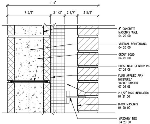
D3 | TYPICAL WALL SECTION • EXTERIOR MASONRY WALL
